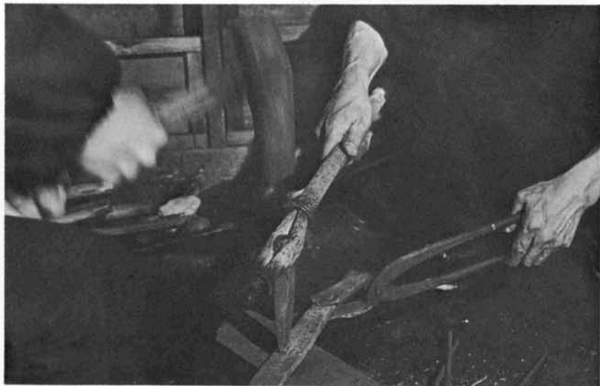
打ち平目(ひらめ)られた鉄は、タガネで細くたち割られる。
