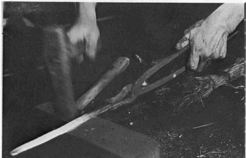
素伸べ(すのべ)と呼ばれる細長い鉄棒も火入れされて打ち鍛えられる。
