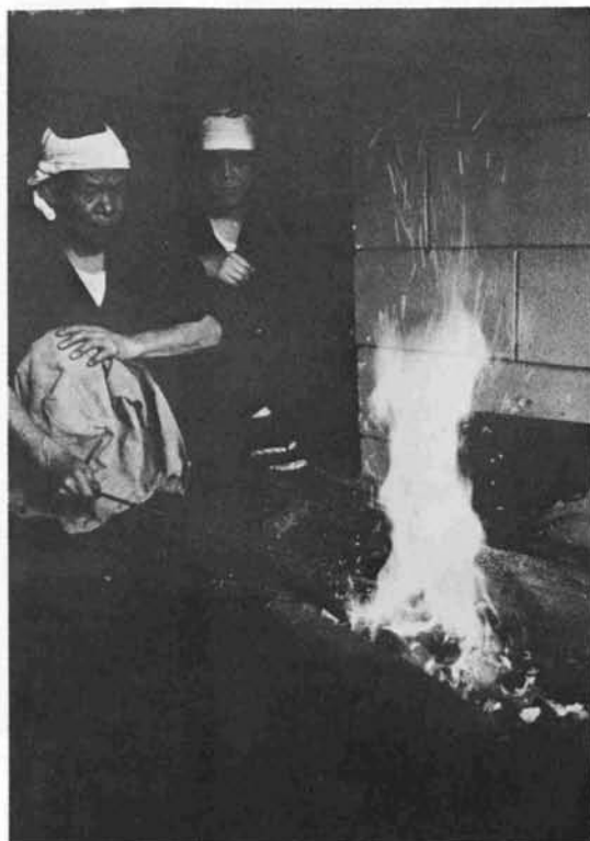
燃え上る松炭、フィゴの強弱で炎の色(温度)がかわる。
