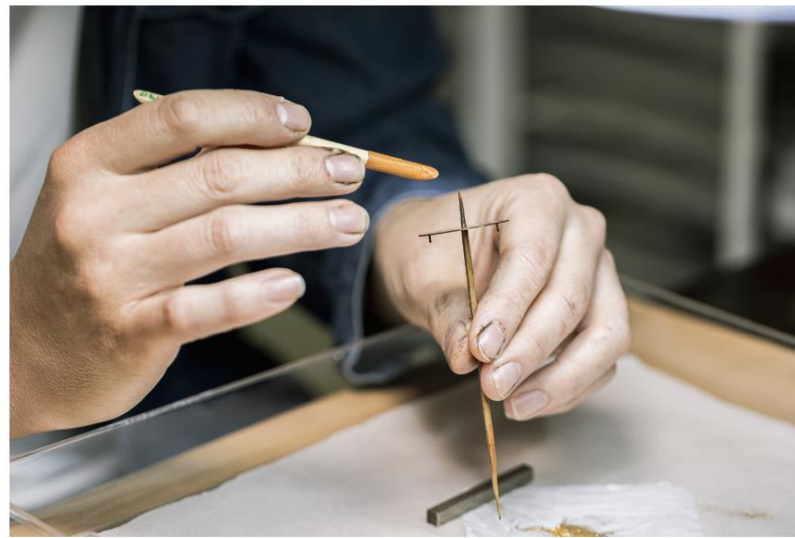
時計の文字盤への漆塗装
